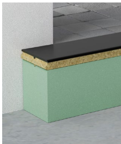
Ciepły próg bramy segmentowej
