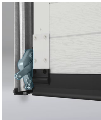
Hamulec bezpieczeństwa uniemożliwiający opadnięcie skrzydła w przypadku uszkodzenia linki
