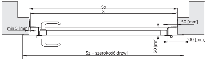
Montaż w otworze - przekrój poziomy.
