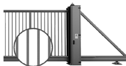
Wypełnienie w postaci kształtowników zamkniętych 25x25mm w układzie caro - spawanych do konstrukcji.
