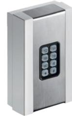
Funktioniert mit einem Funkempfänger WIŚNIOWSKI 868 MHz zusammen. Steuerung: bis zu fünf Geräte. Stromversorgung: Batterie 4 x AA; 1,5 [V]. Schutzklasse IP 54, Reichweite bis zu 30 m. ENTRAcodE+ ist ein drahtloses Gerät, das keine Verkabelung erfordert und für die Aufputzmontage vorgesehen ist.
