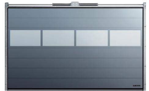
In einem UniPro-Tor kann eine Verglasung mit Alupaneel ohne oder mit thermischer Trennung angewendet werden. Bei dem Paneel wird doppeltes Acrylglas - Paket 21 [mm] eingesetzt. Das Tor kann mit einer oder zwei Aluminiumpaneelen ausgestattet werden.
