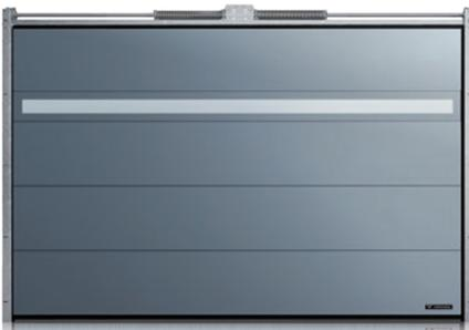
Alupaneel mit oder ohne thermische Trennung, für Tore  $So \leq 3000$  ohne Sprossen, für Tore  $So > 3000$  mit jeweils einer Sprossleiste. Die Höhe des Horizon-Paneels beträgt 215-250 [mm], je nach Gesamthöhe des Tores. Das Paneel wird auf beiden Seiten mit der Außenfarbe des Tores lackiert. Das Aluminiumpaneel ohne thermische Trennung kann mit einem LED Streifen.
