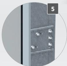
**5 Mit den Führungsschienen verschraubte Zargen**
