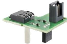
Zusatzplatine mit Signal- und Impulseingängen. Definiertes Öffnen und Schließen. Kann an kabelgebundene Smart-Home-Systeme angeschlossen werden.
