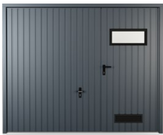
Schwingtor mit Lüftungsgitter K-1 und Verglasung in der vertikalen Ausführung A/H, in einem Tor mit Schlupftür.
