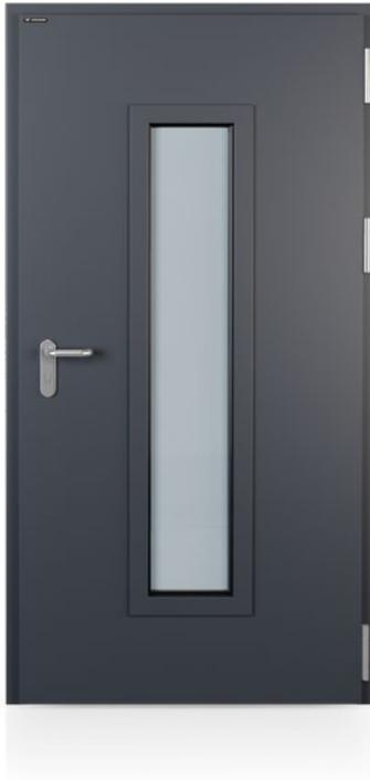
Die Stahl-Mehrzwecktüren ECO Tech sind einflügelige Drehtüren „mit einem dicken Falz“. Sie bestehen aus einem vollflächigen oder teilweise verglasten Türblatt sowie einer Stahlzarge – wahlweise mit automatischer Absenkdichtung oder mit festem Schwellenprofil und Absenkdichtung. Außentüren sind pro Türblatt mit drei Stk. Bandseitensicherungen ausgestattet.
