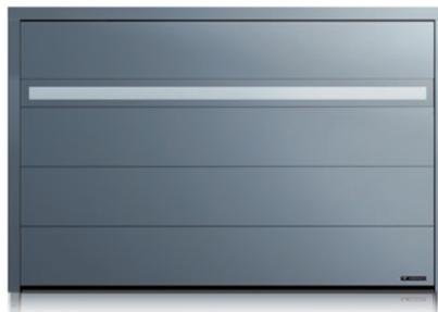
Pannello in alluminio senza taglio termico o a taglio termico. Per il portone  $So \leq 3000$  senza traversa, per il portone  $So > 3000$  con una traversa. Altezza del pannello Horizon 215-250 [mm] a seconda dell'altezza totale del portone. Il pannello è verniciato su entrambi i lati nel colore esterno del portone. Pannello in alluminio senza taglio termico può essere dotato di illuminazione con nastro LED.
