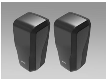
**FOTOCELLULE** - fissate sui pali del cancello - se nella luce di passaggio appare un ostacolo, si perde il segnale infrarosso il che ferma il cancello.
