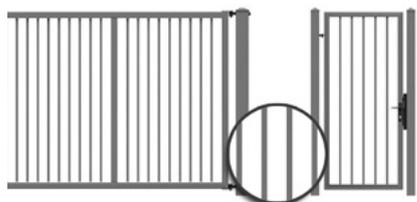
Riempimento in profilati chiusi 30x18mm saldato alla struttura.
