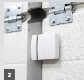
Capteur d'ouverture* empêche le fonctionnement de la porte si le portillon est ouvert. L'option portillon incorporé de la porte automatique comprend un capteur d'ouverture du portillon.
