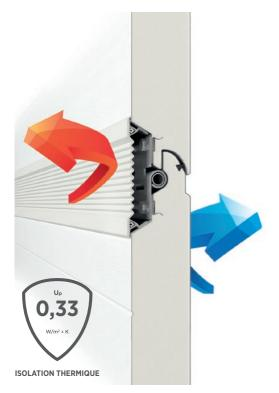
Pour le panneau INNOVO, le coefficient de transfert thermique est de Up = 0,33 W/m $^2$  × K.
