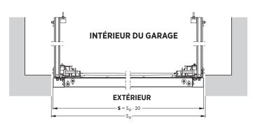
Pose dans la baie (en tunnel) (coupe horizontale) des portes KOMFORT, SELECT, CONNECT.
