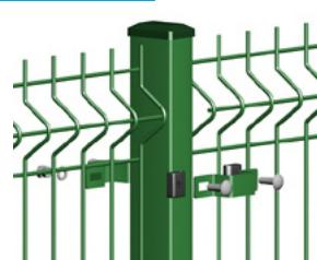
**Poteau en profil 60x40x1,5 [mm], poteau h=3200 [mm] 60x40x2 [mm].** Le poteau est équipé d'un bouchon en matière plastique.
