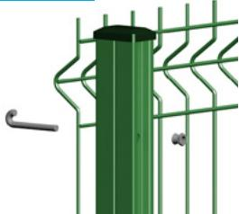
**Poteau profilé en tôle galvanisée.** Solution brevetée par l'entreprise WIŚNIOWSKI. La forme du poteau conçue pour des raisons de sécurité des utilisateurs (l'écrou est situé dans le creux de la forme du poteau). Le poteau est équipé d'un bouchon en matière plastique et possède des trous facilitant le montage.
