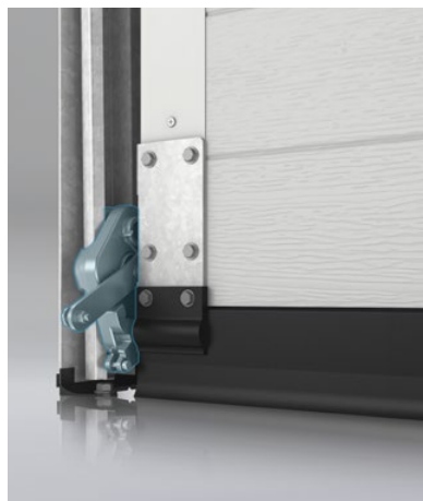
Bezpečnostní brzda znemožňující pokles křídla vrat v případě poškození nosného lanka
