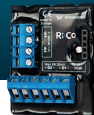
Ri-Co Pro Set * (wersja zaawansowana rozszerzona) (rozsířená pokročilá verze) Skládá se z ovládače Ri-Co Pro včetně vnějších magnetických koncových spínačů, díky kterým dostáváme informace o stavu vrat. Možnost použít toto zařízení v kolejnicových pohonech Automatik SOMMER.
