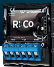
Ri-Co (základní verze) Ovládač umožňuje otevření a zavření vrat.
