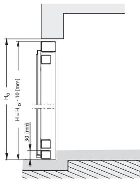
**Montáž před stavebním otvorem** - svislý řez
