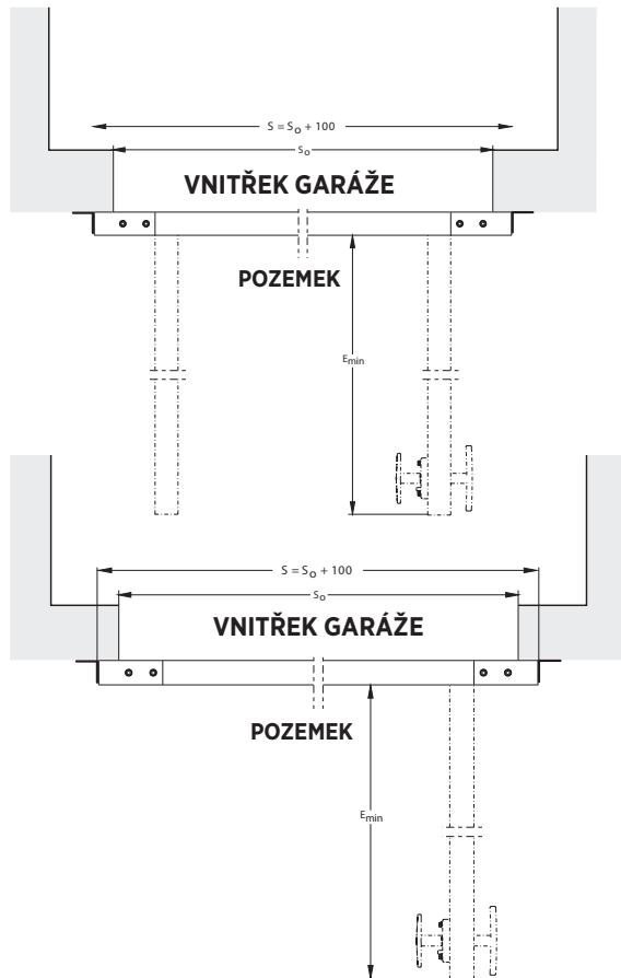
**Montáž do stavebního otvoru** - svislý řez
