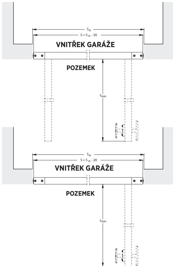
**Montáž před stavebním otvorem** - vodorovný řez.
