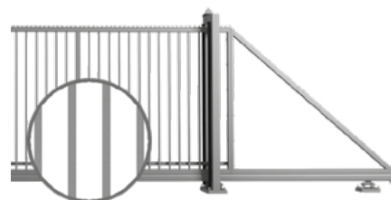
Výplň v podobě uzavřených profilů 25 x 25 mm poskládaných do vzoru CARO přivařená ke konstrukci.
