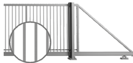
Výplň v podobě uzavřených profilů 30 x 18 mm přivařených ke konstrukci.
