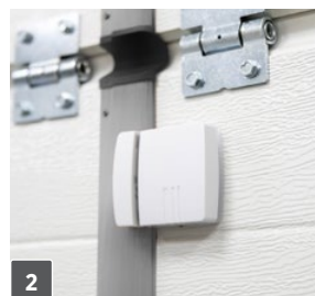
Capteur d'ouverture du portillon empêche le déclenchement de la porte si le portillon incorporé est ouvert. L'option de portillon incorporé dans les portes motorisées comprend un capteur d'ouverture du portillon.
