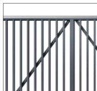
Zagęszczenie wypełnienia (odstęp max. 80 mm)
