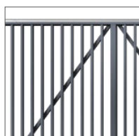
Zastrzały wykonane z kształtownika 40 x 20 zastosowane w każdym wypełnieniu.
