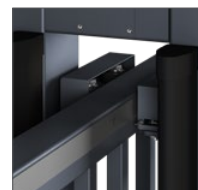
Łożyszkowane rolki prowadzące poruszające się po okładzinie ze stali nierdzewnej gwarantują płynną i cichą pracę bramy.
